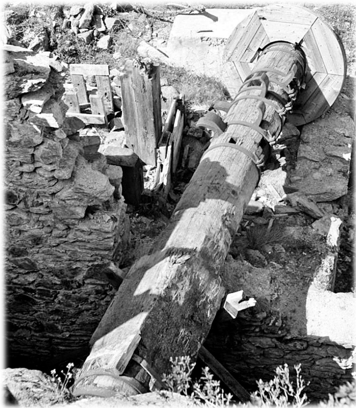
Die mächtige Zapfwelle, welche die 6 Pochstempel antrieb. Gut zu erkennen, die Zapfen zur Anhebung der Pochstempel und rechts davon das Antriebsrad der Transmission.
